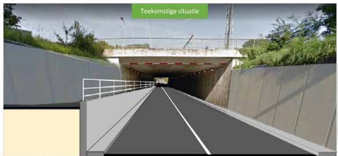
Maatvoering fietspad in tunnels conform ASVV-2012 art. 14.41 (ten minste 2,00 m breed) Maatvoering Gebiedsontsluitingsweg (GOW) 50 km/h, Type I binnen de bebouwde kom Trapopgang niet weergegeven Afbeelding: Google Maps, Streetview
